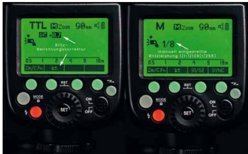
Split-Darstellung Blitzmenü – links TTL-Anzeige, rechts manuell mit Leistungsstufe.
