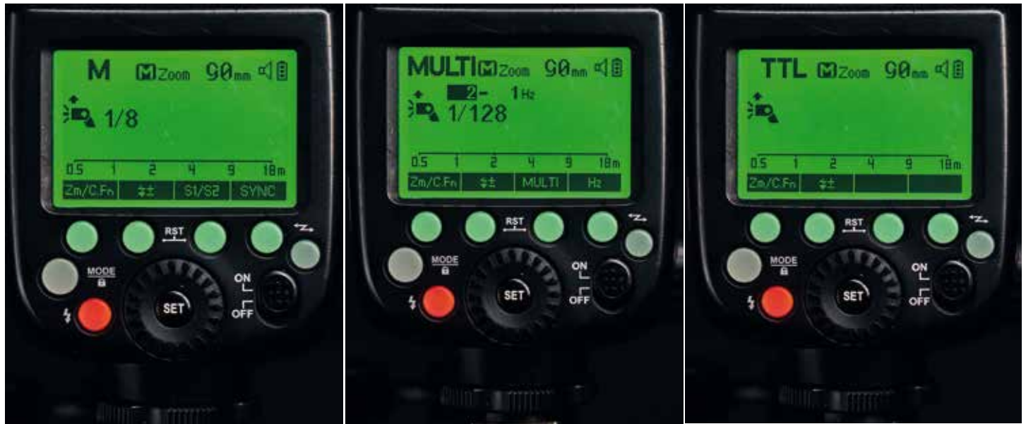
Im Bild das Display und Bedienfeld eines Aufsteckblitzes mit sichtbaren Modi – einmal manuell, einmal multi und einmal TTL.
