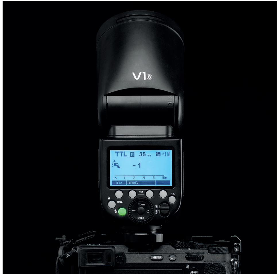
Ein „Systemblitz“ kommuniziert mit dem Kamerasystem, etwa mittels TTL (Through The Lens), also durch das Objektiv gemessene Blitzautomatik. Foto: Robert Pichler
